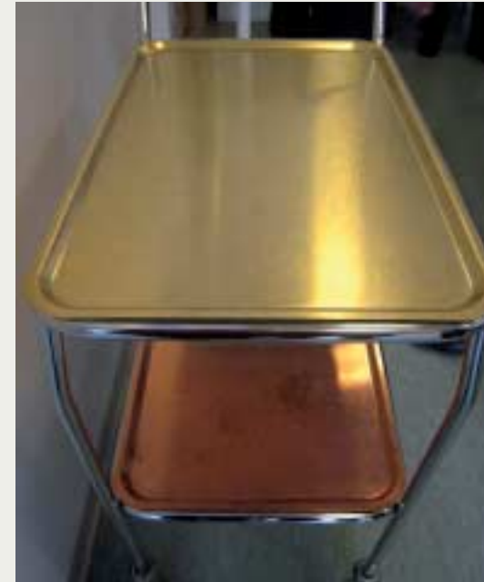
Tarjoiluvaunun yläosa on Nordic Royal -seosta ja alaosa kuparia. Tutkimuksessa käytettiin kahta vaunua ja referensseinä olivat kromatut tarjottimet.
